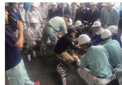
「セルロース断熱材」の燃焼実験
