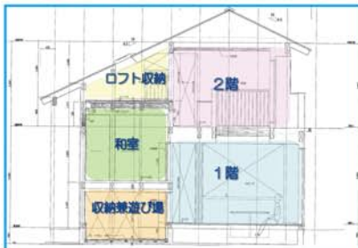
建物断面図。図の左側部分の各部屋が通常の1・2階とずれた高さで床がある構造。
