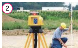
2 整準レーザーレベル（拡大） 同じ高さで赤外線レーザーが360°出ている。
