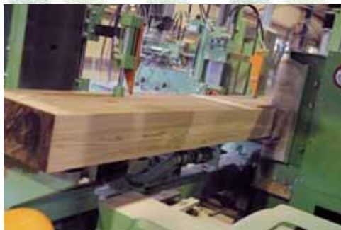
±0.25mmの抜群の精度で製材されます。
