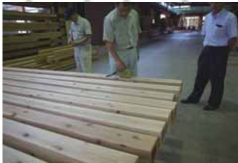
木材の乾燥はしっかりされているか！ 含水率（木材水分率）の検査
