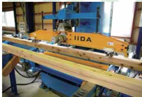
グレーディングマシン（強度測定機）にて 強度測定もしっかり行い出荷されるのです！
