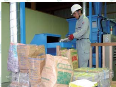
新聞紙を再利用し 裁断機にてセルロースファイバーを製造！
