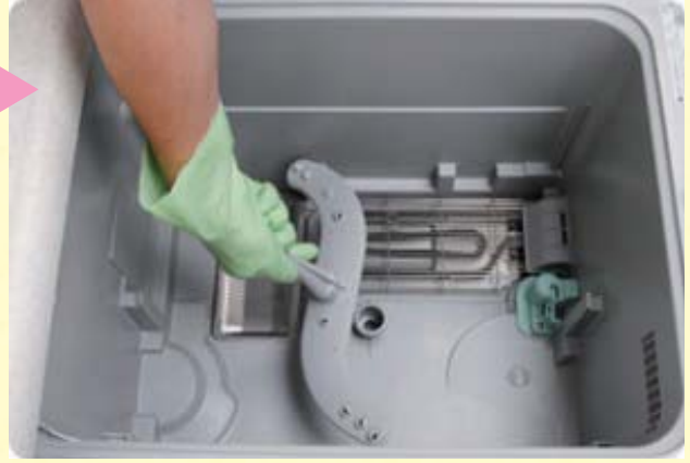
② ノズルの中央をつまんで、真上に引き抜きます。 ※ノズル上部にナットがついているタイプもあります。
