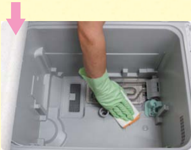
⑤ 庫内全体を柔らかい布で水拭きし、最後に洗った部品を戻します。
