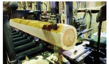
帯鋸で切断中
