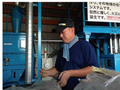
第二工場にて断熱材のセルロースファイバー作り。
